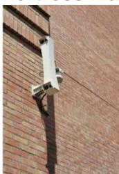
Fortress Multi-Iris est une technologie combinant vision stéréoscopique, capteurs thermiques et algorithmes avancés pour la détection de tout comportements suspects tout en segmentant le type de menace.
